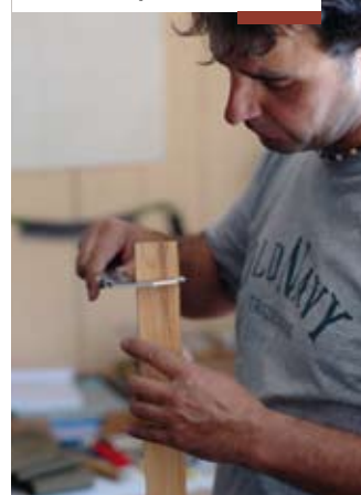
Vérification de l'épaisseur au pied à coulisse
