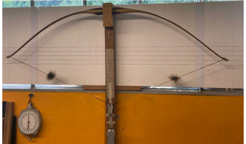
Le banc d'équilibrage permet de vérifier si les branches sont bien régulières.
